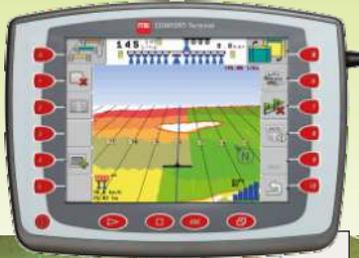
z.B. „Track Guide II“ Parallelfahrssystem
