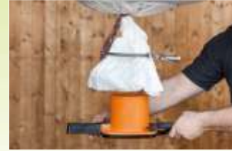
Spannring über Auslass schieben
